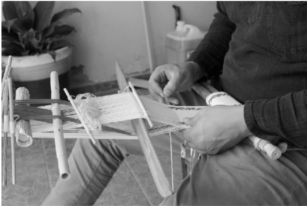
Figura 80. Oscar Vázquez trabajando el telar de cintura aplicando el labrado de urdimbre para plasmar cenefas y figuras a lo largo del textil.
