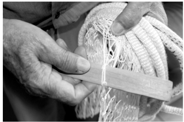
Figura 45. Regla de madera para medir la longitud de cada malla.
