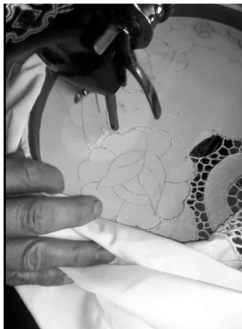
Figura 118. Proceso de bordado a máquina de pedal o calado (foto cortesía de María Navarro).
