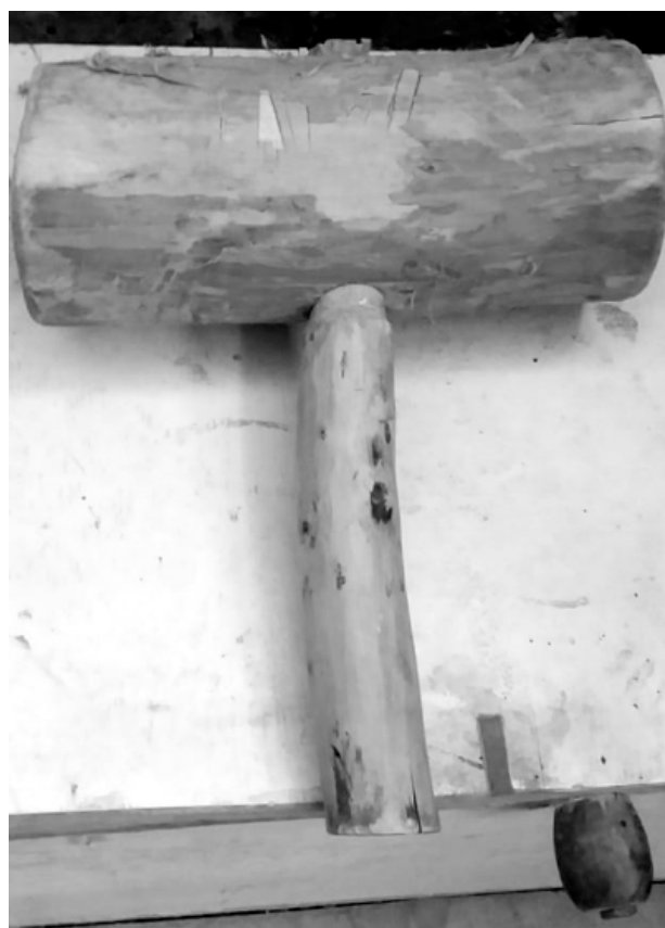
Figura 26. Maso elaborado por don Jesús Velázquez para machucar el otate (foto cortesía de don Jesús).
