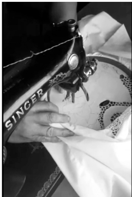
Figura 118. Proceso de bordado a máquina de pedal o calado (foto cortesía de María Navarro).
