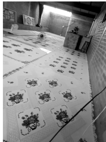
Figura 123. Manteles extendidos para su secado, posterior a la adición de almidón (foto: cortesía de Raúl Carranza)
