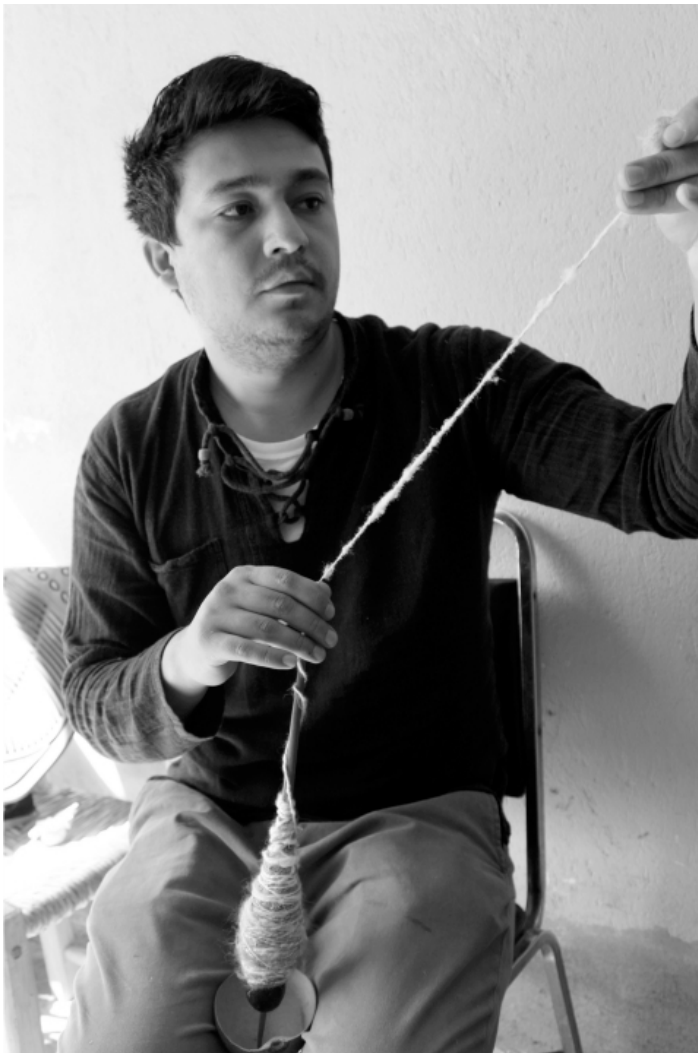
Figura 10. Proceso de hilado de lana con malacate realizado por Óscar Vázquez.
