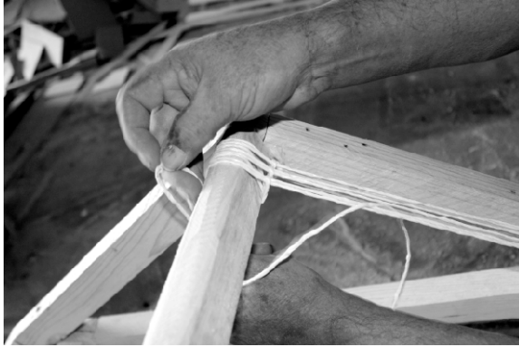
Figura 21. Disposición de hilos verticales en el marco de un asiento de una silla. Se puede observar cómo se utiliza una sola hebra, la cual va cubriendo la totalidad del marco al tiempo que se va tensando por la forma en la que se va tejiendo
