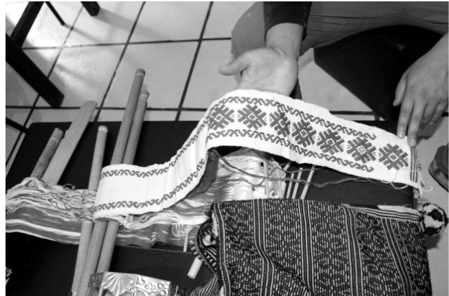
Figura 81. Tejido elaborado mediante telar de cintura con labrado de urdimbre por Oscar Vázquez.
