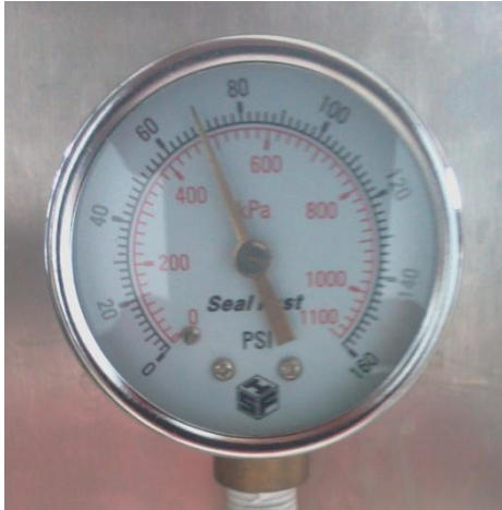
Manómetro Seal Fast indicando los Psi aplicados (en este caso 70 Psi).
